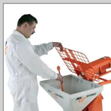
► Intensidad de mezcla flexible debida a dos entradas de agua, lo que permite la elaboración de muchos materiales.
